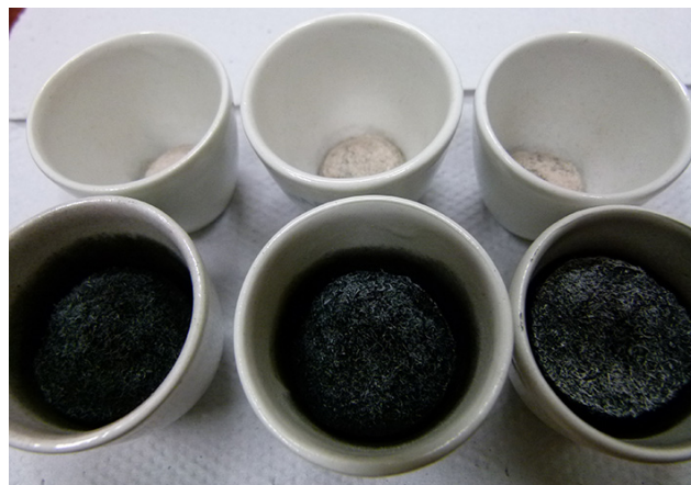
Figura 3.4: Fotografia dos cadinhos após análise imediata. Cadinhos da parte superior: Cinzas da determinação do teor de cinzas; Cadinhos da parte inferior: Carvão da determinação do teor de voláteis.
