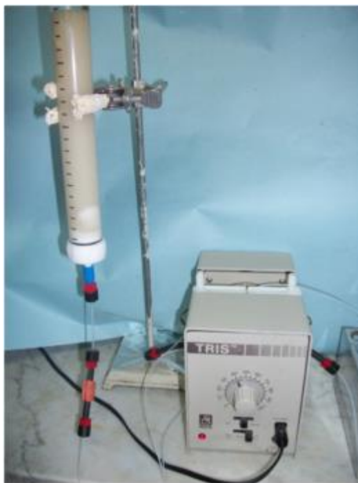
Figura 11: Sistema cromatográfico con bomba peristáltica empleado para la separación de los extractos de Melia azedarach.
