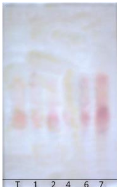
Figura 9: TLC revelada por DMAB mostrando las fracciones resultantes del proceso descrito en el texto comparado al patrón de toosendanina (T). Se puede evidenciar que todas las fracciones revelan aparentes compuestos limonoides.
