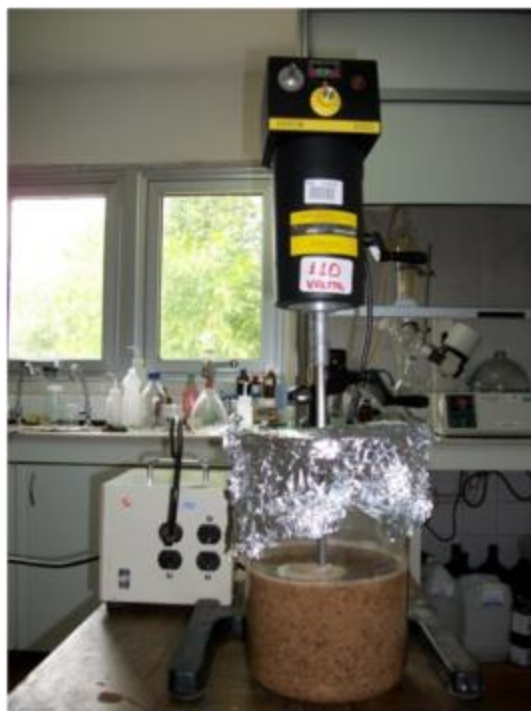
Figura 7: Dispositivo empleado para la extracción de material vegetal en el procedimiento de obtención de los limonoides a escala preparativa a partir de los frutos de M. azedarach .
