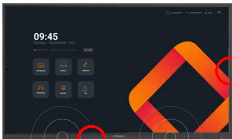
**PRENDER EL INTERRUPTOR EN LAS ESPALDAS DE LA PANTALLA, AL LADO DEL CABLE DE ALIMENTACIÓN DEBAJO DEL EQUIPO.**
