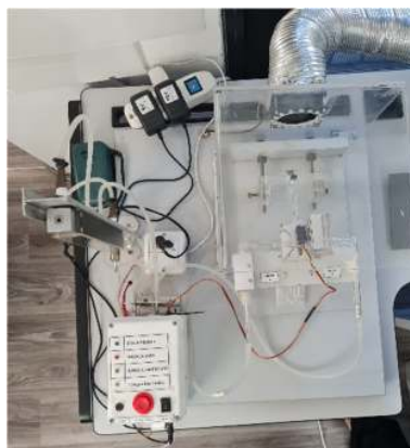
Figura 1. Sistema automatizado para la liberación de estímulos volátiles en ensayos de aprendizaje y memoria en abejas.
