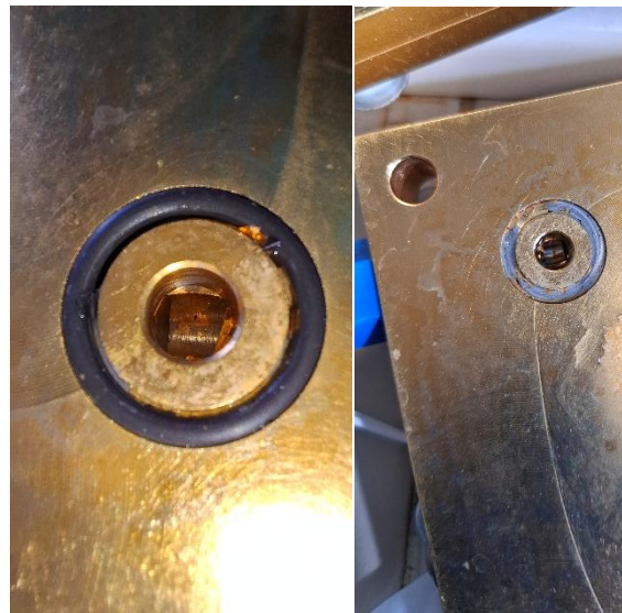
Figura 16 – Cuerpo de la celda de electrolisis PEM. Se muestra la entrada de agua con y sin su correspondiente o-ring.
