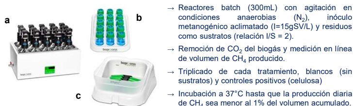
Figura 2. Determinación de PBM utilizando el AMPTS II (Bioprocess Control). a. Reactores en batch. b. Lavado de gases. c. Medición y registro de volumen de CH 4 en línea.
